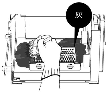
ストーブ炉内に残っている燃焼灰は、全ては掃き落とさず少量残してください。薪を使った場合、燃焼灰がある程度残っていると火持ちがよくなります。また、ストーブ炉内の部品を熱から保護する断熱材の役目も果たします。
