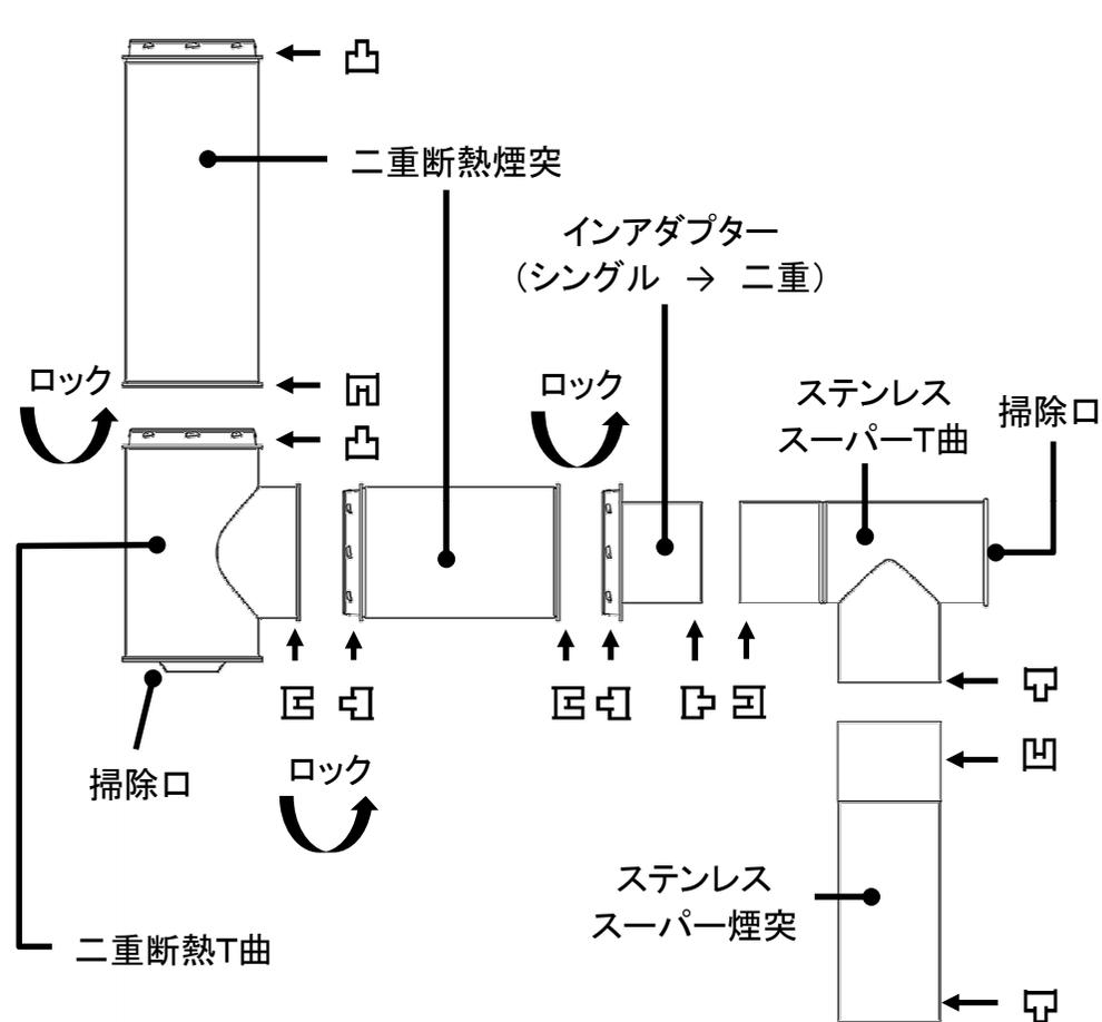
煙突の種類によって接続方法および方向が異なります。逆向きに取り付けは行えませんので、十分に確認を行ってから設置してください。
